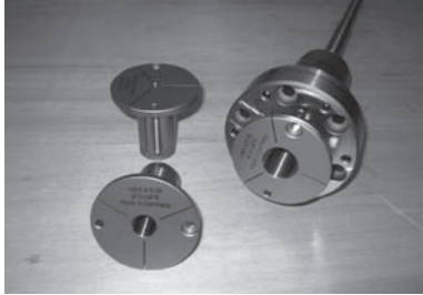
Hydro-Dehndorn-Flansch auf Spindel montiert!!!!
