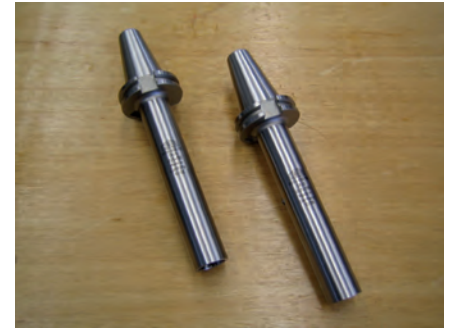
SK-40 x \varnothing 25 x \varnothing 32 x 190 Art.-Nr. 4004-608.00
