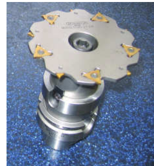
HSK-A63 x \varnothing 20 x 34 x 160 Art.-Nr. 4003-131.00
